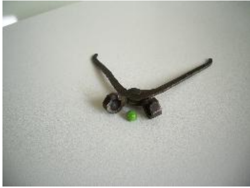
Denne ”tanga” ble brukt til å støpe kuler til fuglerifla. (Ei ert er brukt som referanse for størrelsen av kula.) (Foto: Harald Sandmo.)
